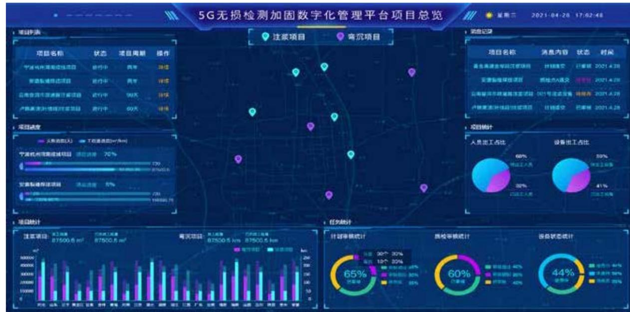
5G 无损检测加固数字化管理平台是通过无人机、3D 相机、探地雷达、地震波传感器等先进技术，实时采集公路大比例尺矢量数据、高分辨率影像数据、GIS 信息数据，对道路桥梁病害数据进行处理分析，实现病害实时诊断、分析与评估，为道路桥梁全寿命周期养护方案制订提供数据支撑，提升公路养护决策与设计、施工管理水平。
