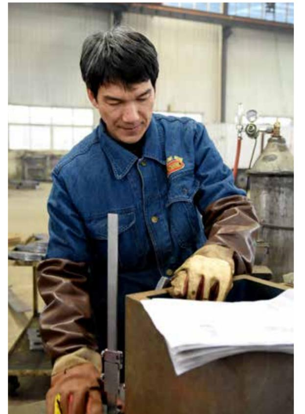
对照设计图纸，进行精准测量和定位，是保证焊接质量的前提，老陈工作起来一丝不苟！
