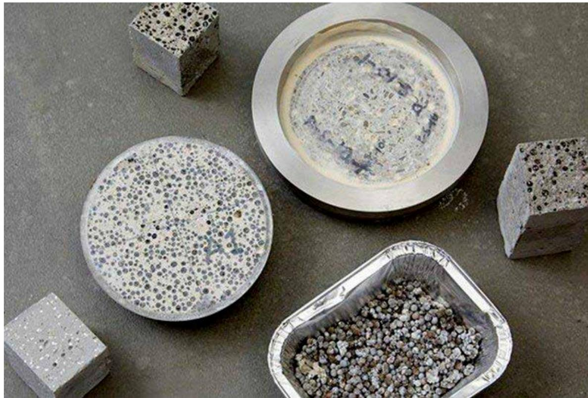
能制造出石灰石的细菌胶囊被嵌入了混凝土中。（荷兰代尔夫特科技大学）
