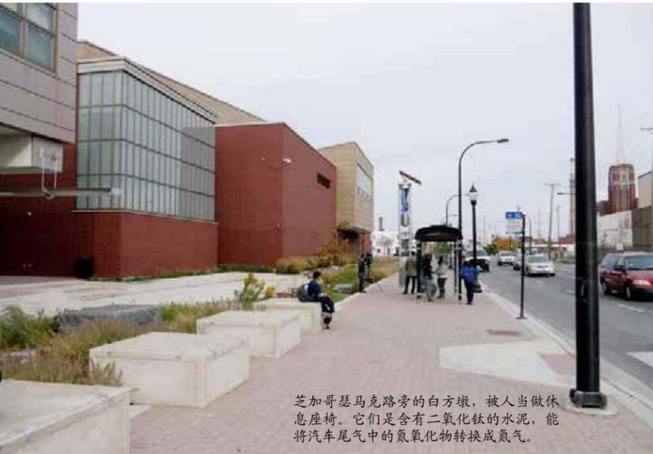
芝加哥瑟马克路旁的白方墩，被人当做休息座椅。它们是含有二氧化钛的水泥，能将汽车尾气中的氮氧化物转换成氮气。
