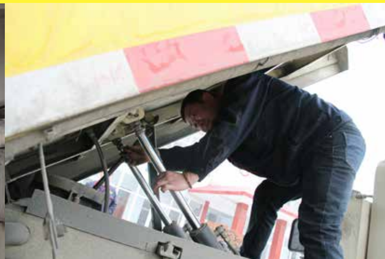
㊟ 发现扫路车后吸盘吸筒有垃圾阻塞,刘旗现场进行清理。
